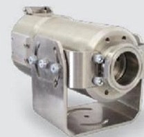
TM-J-TIM; TM-J72-TIM 冷却用ジャケット (長さ 228mm, Ø89mm) 調整可能な取付ブラケット TM-JAB-TIM付き; 推奨の高温用ケーブル TM-USBC5H-TIM (最大 240°C)
