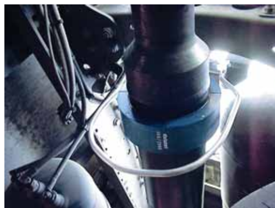
図 1: トラックカルダンシャフトのトルク計測
