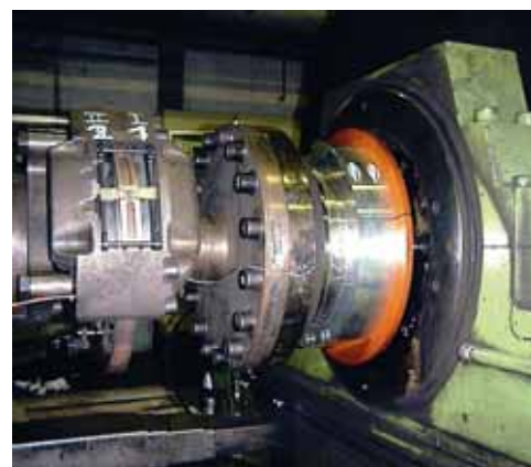
図 4: ブレーキテストスタンドでの温度計測
