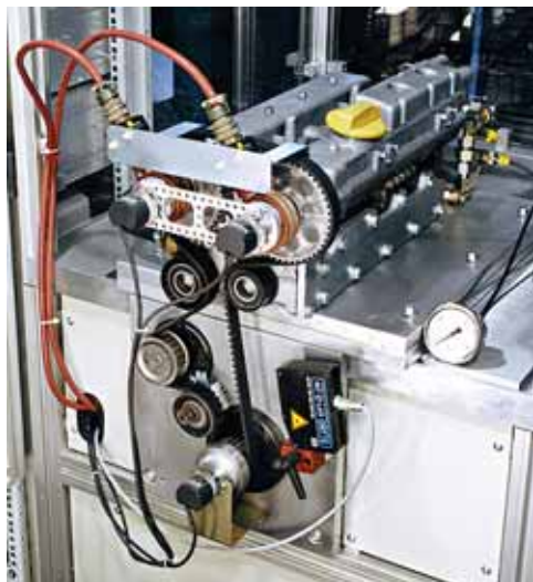
図 5: クラムシャフトテストスタンドにおけるトルク計測
