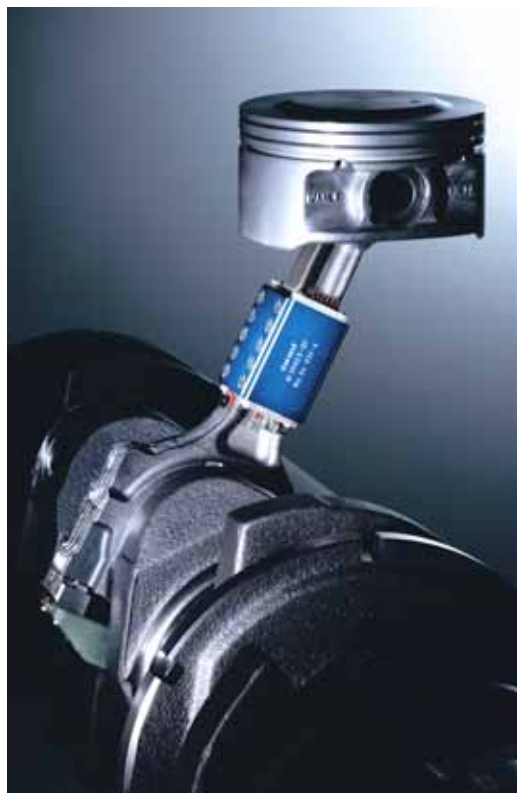
図 6: ピストン温度計測
