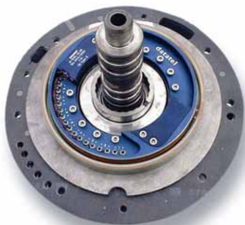
図 2: 自動変速機の温度計測
